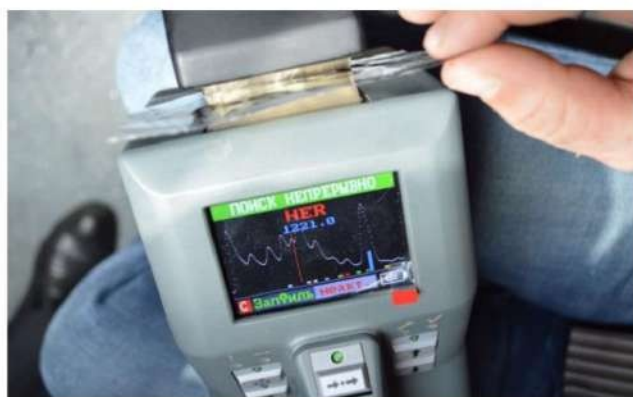
Анализ частиц на пробоотборной салфетке — обнаружение следов героина
